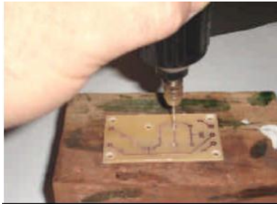
Figura 78. Fotografía proceso de perforación
