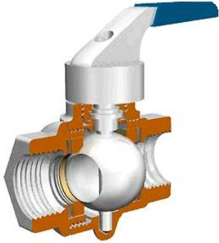
Figura 56. Válvula de bola abierta
