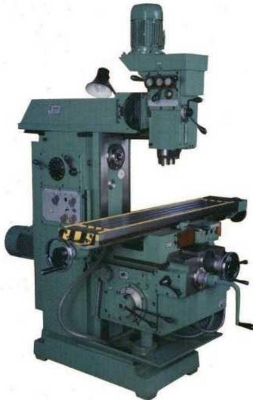
**Figura 3. Fresadora convencional<sup>4</sup>**
