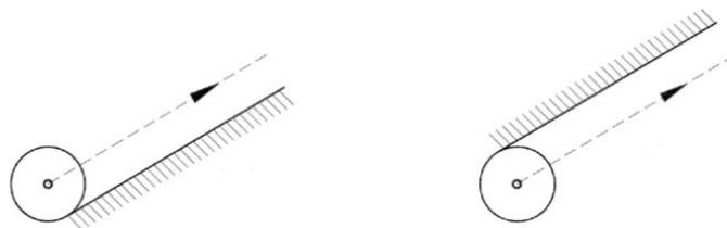
**G41:** La herramienta queda a la izquierda de la pieza según el sentido del mecanizado.
