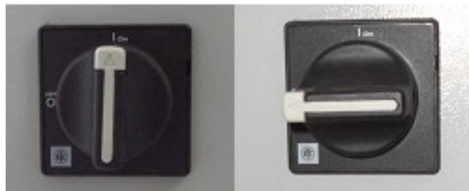
**Figura 48. Perilla de encendido y apagado de la fresadora.**
