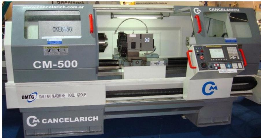
Figura 6. Torno de control numérico<sup>9</sup>
