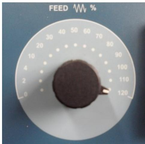
**Figura 45. Perilla de regulación de revoluciones de avance FEED**
