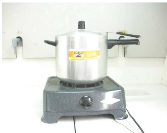
Figura 14. Montaje empleado para la extracción del aceite a partir de residuos grasos de pollo.
