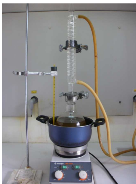
Figura 11. Montaje de reacción para la obtención de biodiesel a partir de residuos grasos de pollo.
