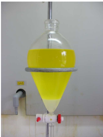
Figura 12. Lavado del biodiesel a partir de residuos grasos de pollo.
