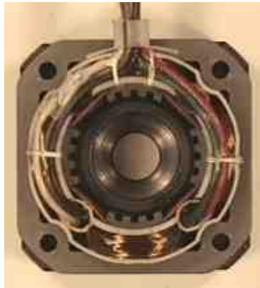
Imagen 8.9 Estator de 4 bobinas
