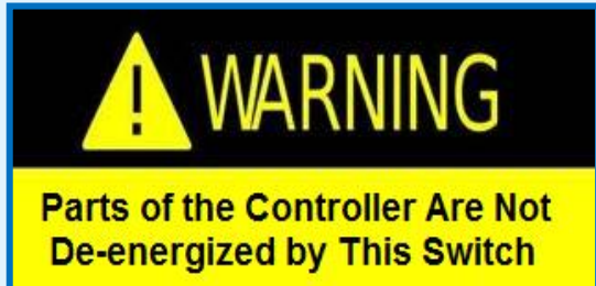
Figura 620-15. Aviso: “Atención - Partes de este controlador no quedan desenergizadas con este interruptor”
