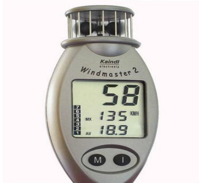
Figura 7. Anemómetro digital windmaster 2
