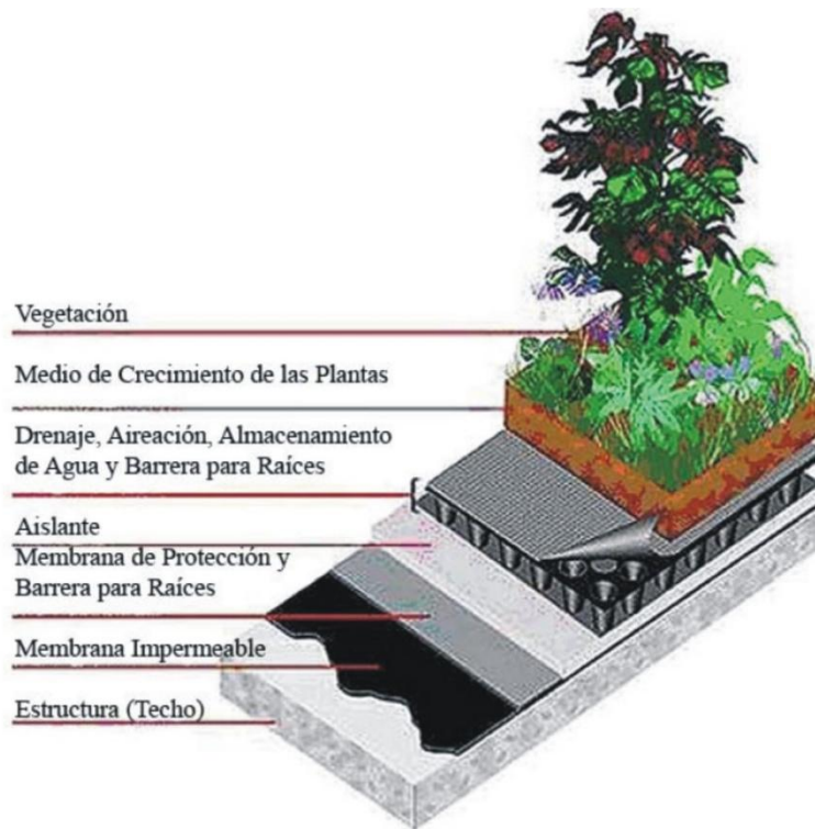
Figura 14. Sistema de cubierta verde
