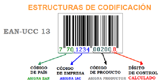
Figura 4. Estructuración de Codificación Código de Barras 4
