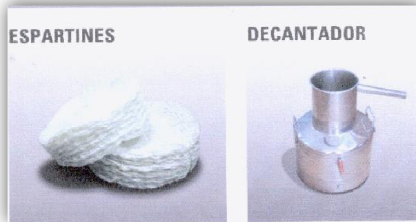
Ilustración 10 Capachos y Decantador
