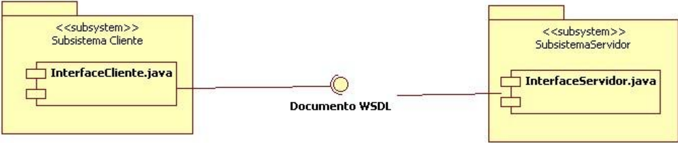
Figura 158. Diagrama de Subsistemas
