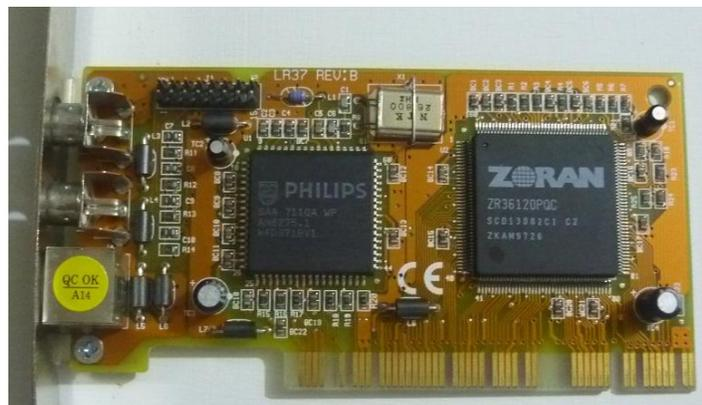
Figura 3.62: Tarjeta de Video LR37 para PC
