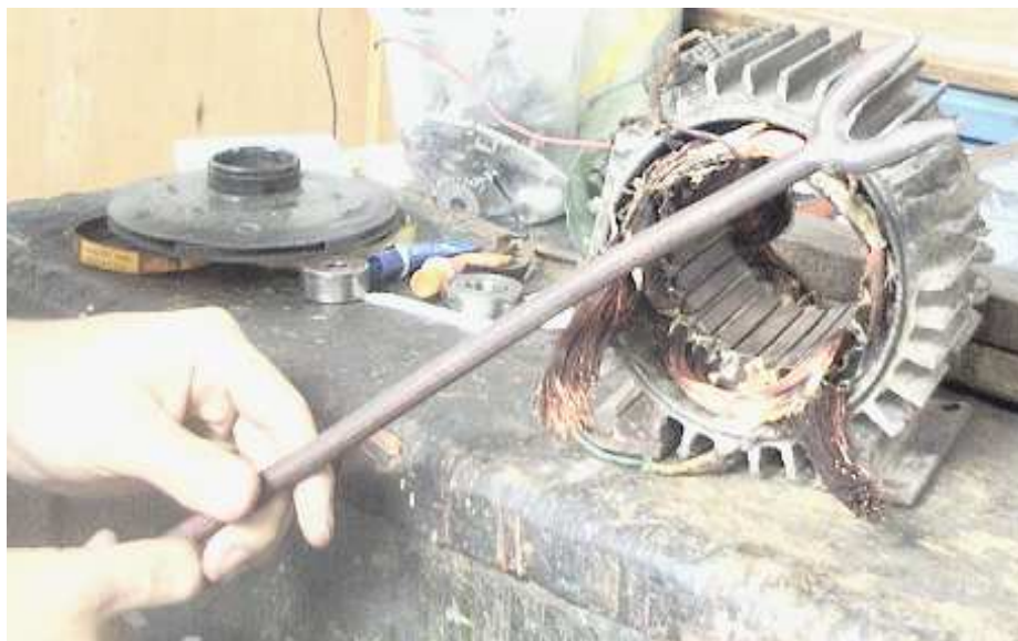
Figura 2.7. Ubicación de de la varilla para la extracción de la bobina.
