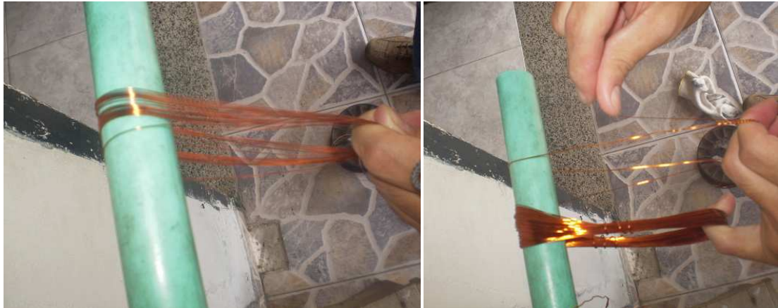
Figura 2.19. Confección de bobinas
