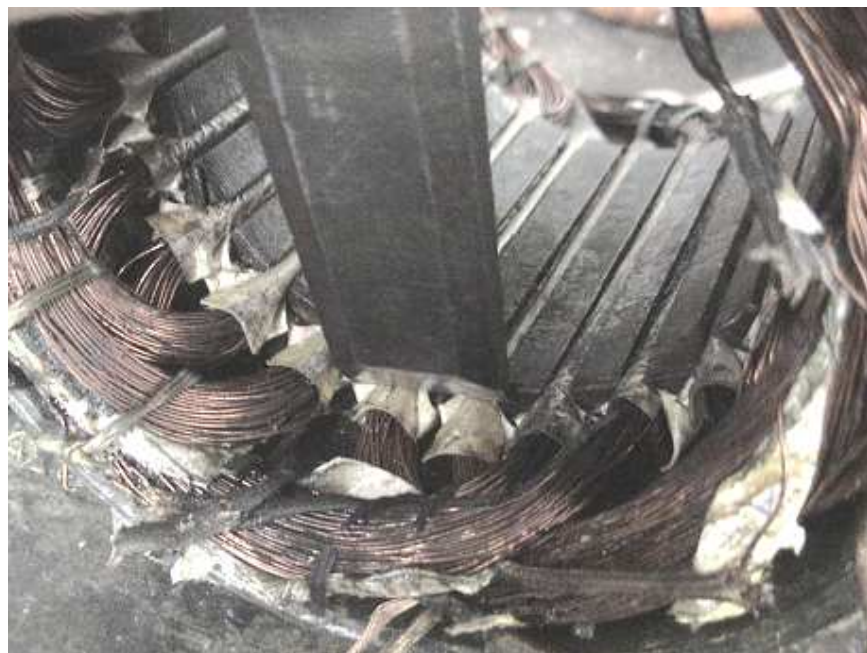
Figura 2.5. Ubicación del formón para el corte de bobina.
