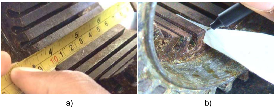
Figura 2.13. Medición del largo y alto de la ranura.
