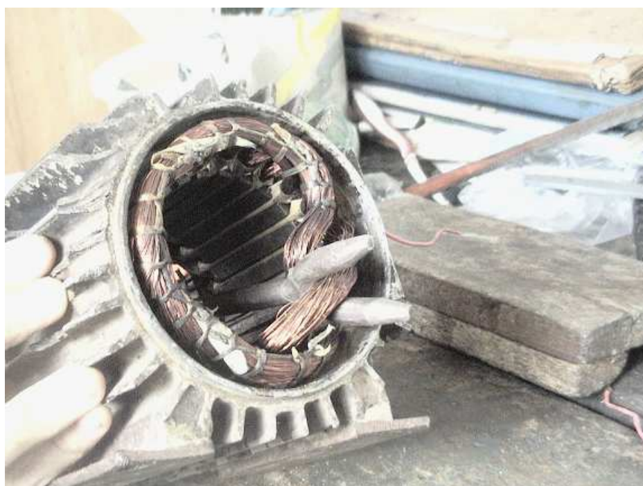
Figura 2.7. Ubicación de de la varilla para la extracción de la bobina.
