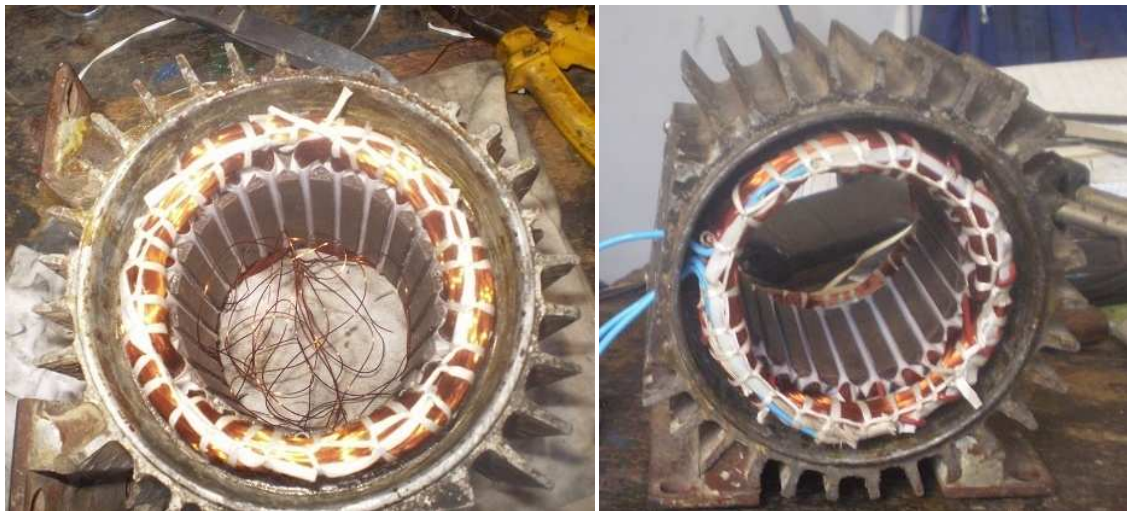
Figura 2.23. Amarrado del bobinado.
