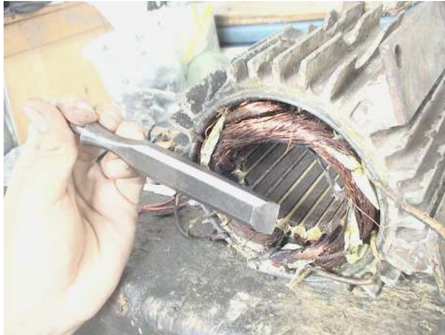
Figura 2.5. Ubicación del formón para el corte de bobina.
