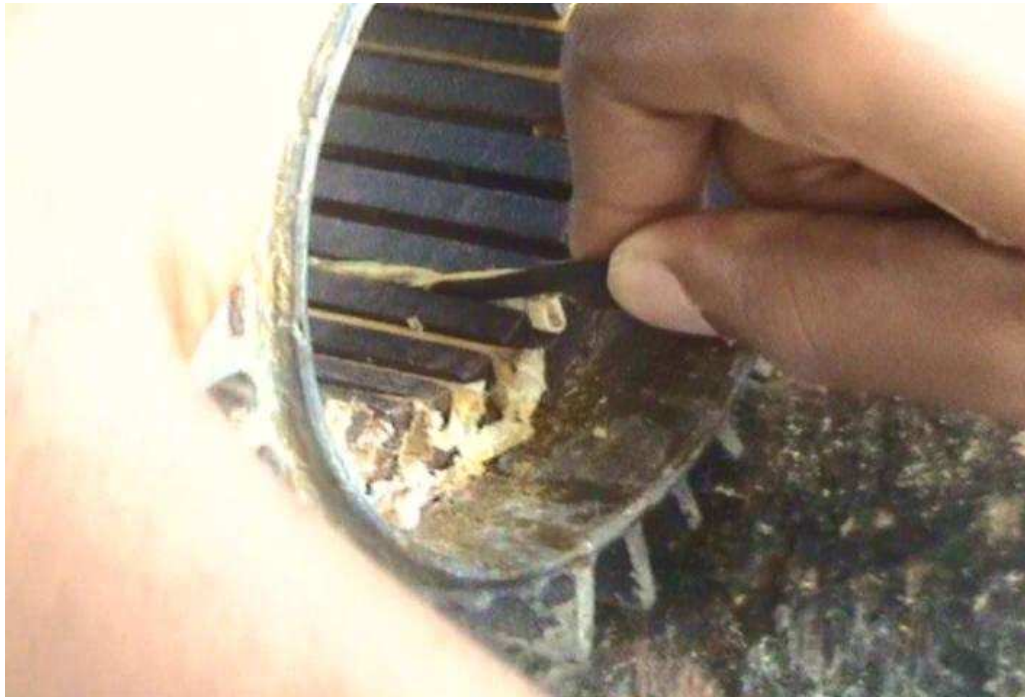
Figura 2.11. Limpieza del estator.
