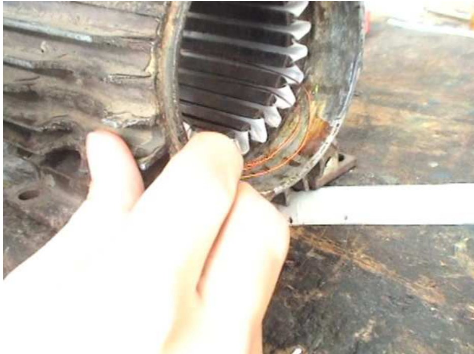
Figura 2.18. Molde de la bobina terminado y verificación de tamaño.
