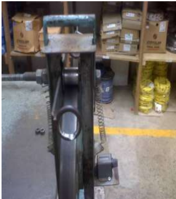
Figura 6.7. Rueda de máquina cuenta metros de cable
