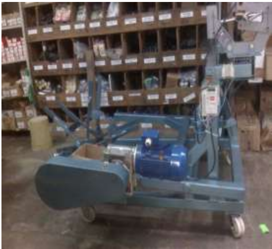
Figura 6.10 Rueda de máquina cuenta metros de cable replegada
