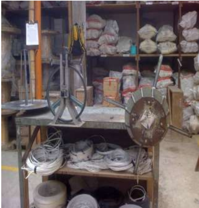
Figura 6.5. Ruedas para carretes de máquina cuenta metros
