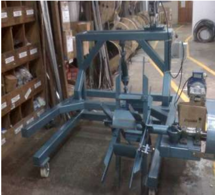
Figura 6.9. Máquina cuenta metros de cable nueva
