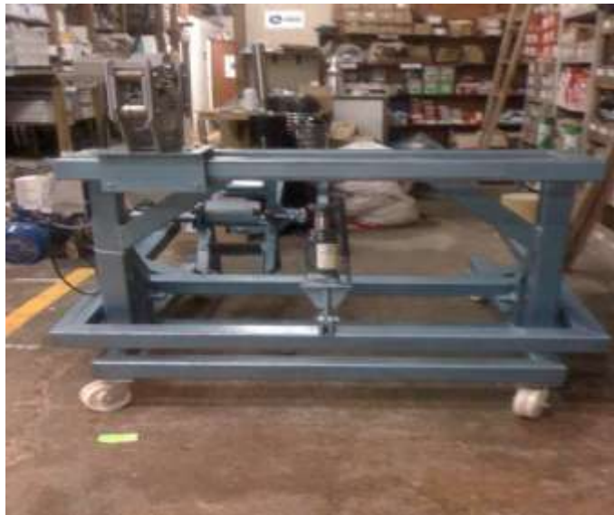
Figura 6.8 Bastidor de máquina cuenta metros de cable nueva
