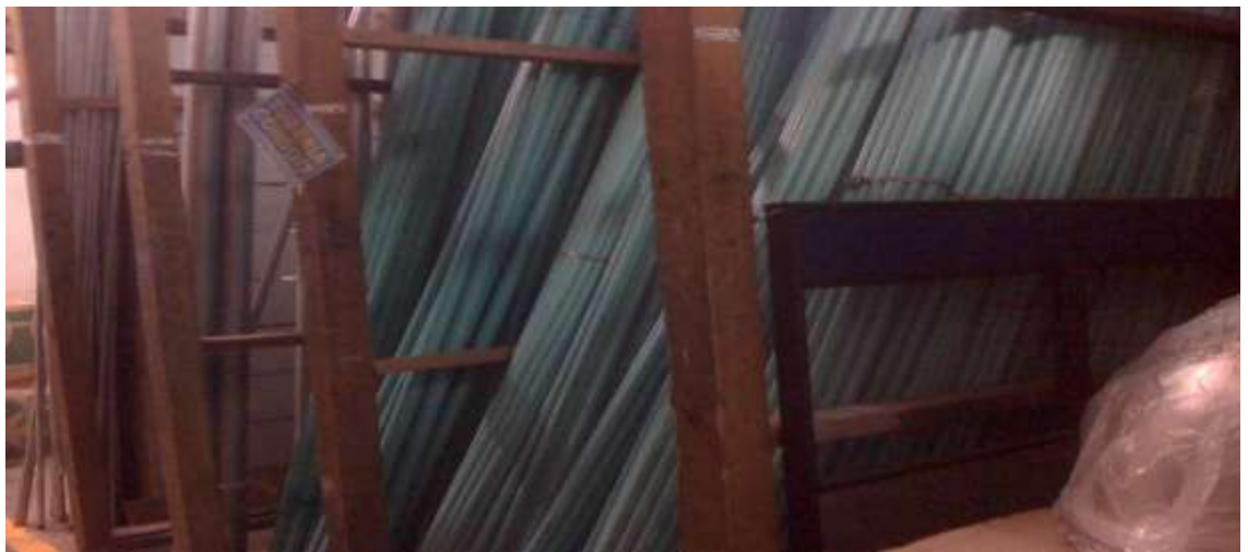
Figura 6.19 Disposición en bodega de la tubería PVC
