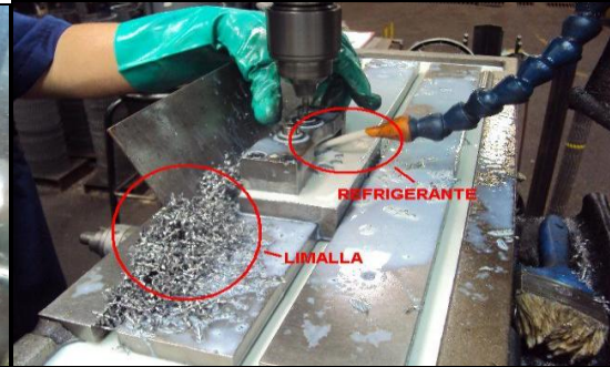
Foto No. 13 Refrigerante
