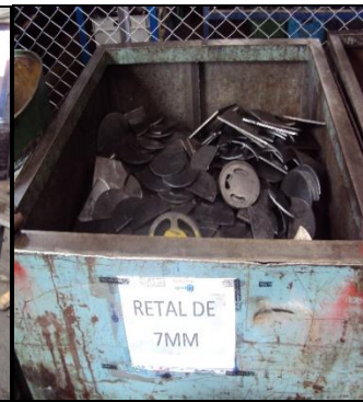
Foto No.6 Residuos de Acero 7mm
