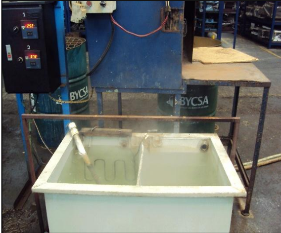
Foto No.21 Tanque galvanizado
