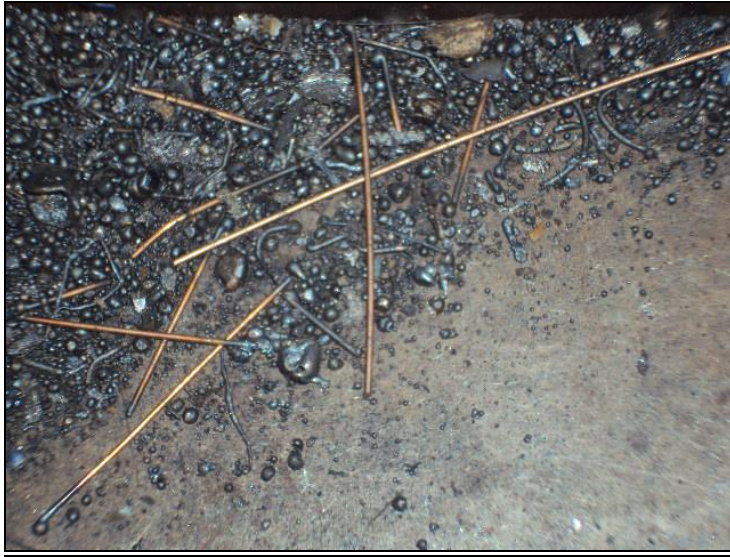
Foto No.20 Residuos del proceso de Soldadura
