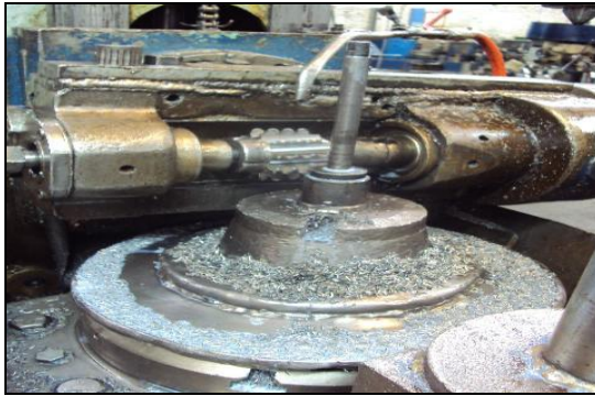
Foto No.10 Residuo limalla con refrigerante
