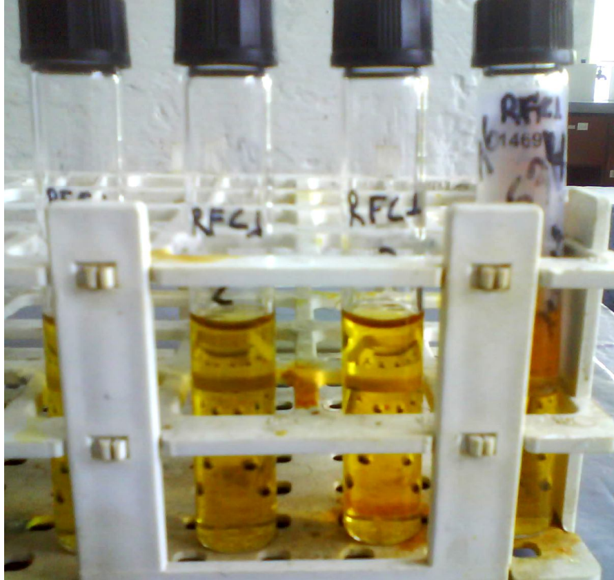
Figura 14: Muestras Tratadas y listas para la medición de DQO
