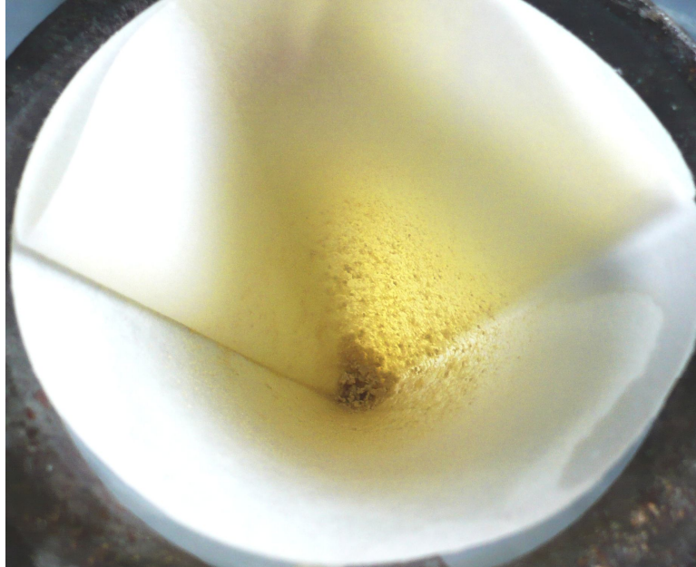
Figura 10: Separación de partículas floculadas por filtración.
