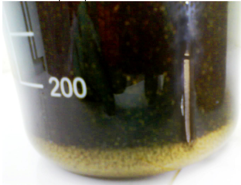
Figura 9: Flocs formados por el proceso de floculación
