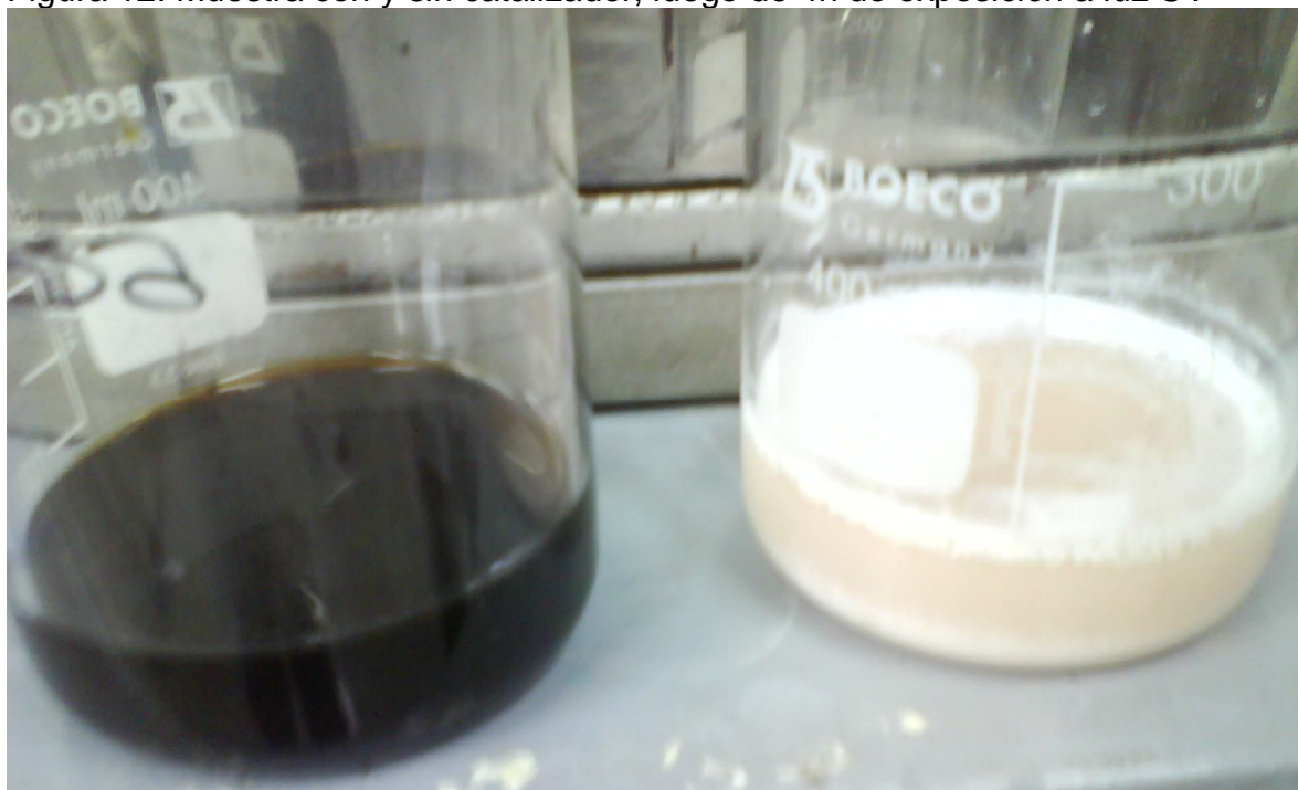
Figura 12: Muestra con y sin catalizador, luego de 4h de exposición a luz UV
