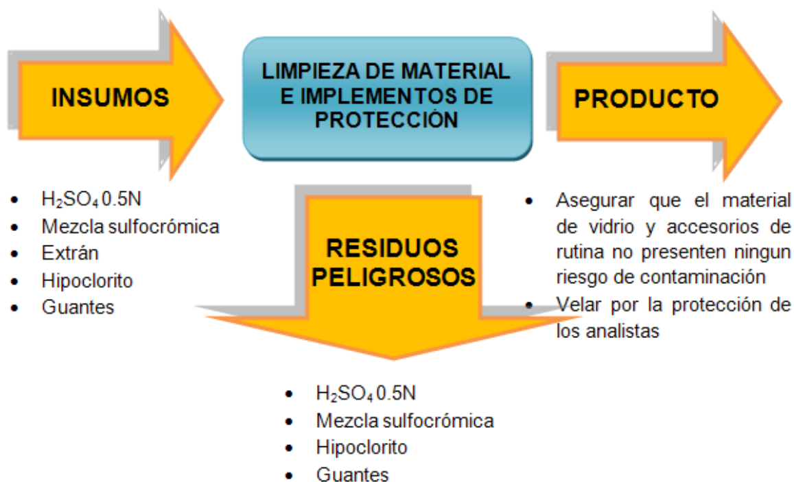
Figura 25. Diagrama de flujo de limpieza de material e implementos de protección en el Área de Química.
