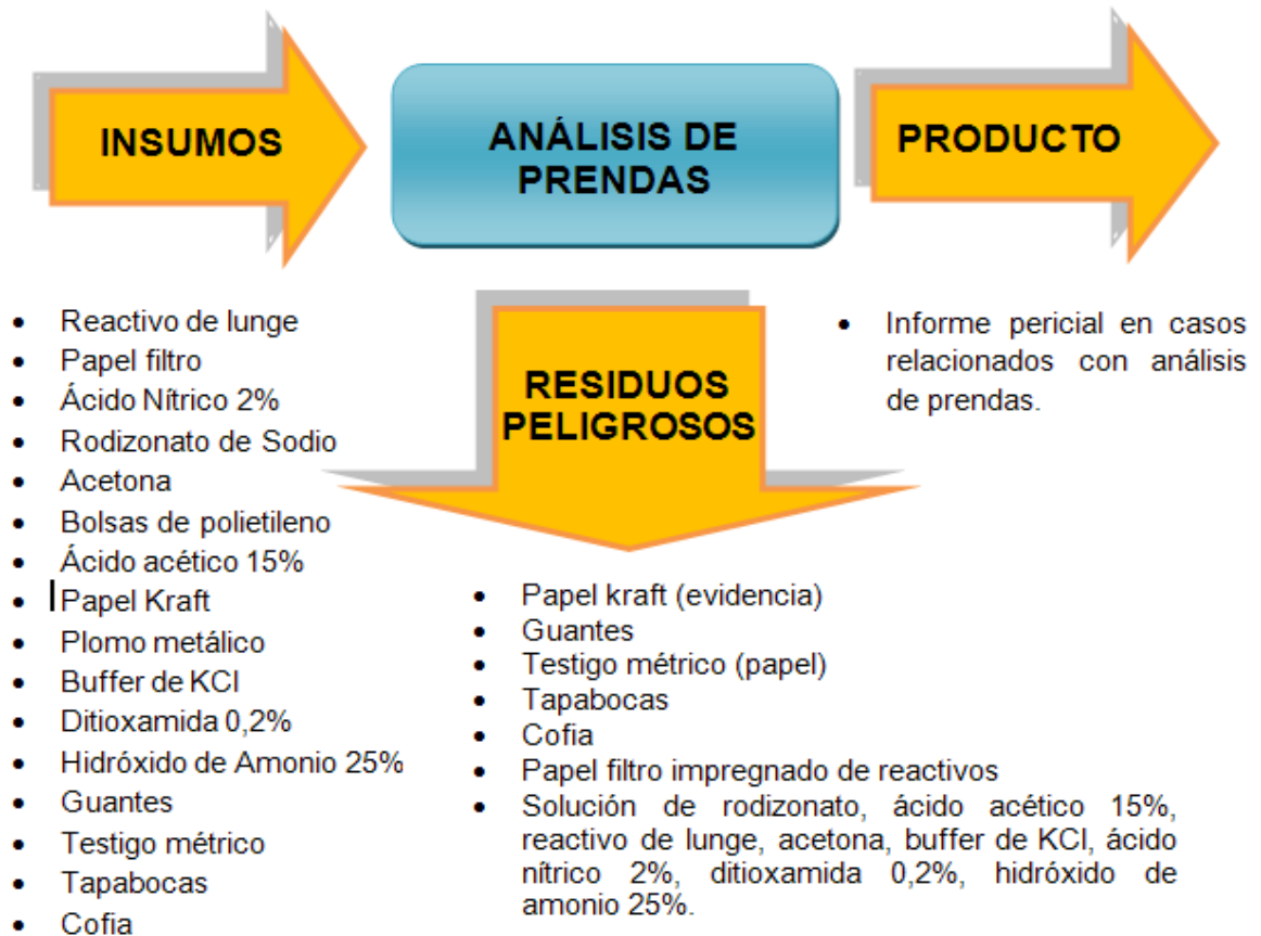
Figura 8. Diagrama de flujo del análisis de prendas en el laboratorio de Balística.
