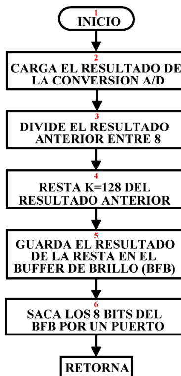
Figura 6.24. Diagrama de flujo de la conversión A/D
