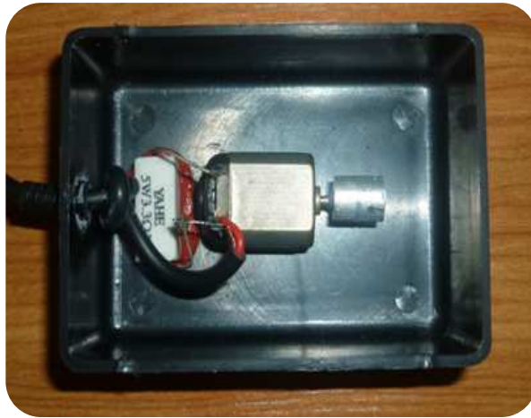
Figura 2.3. Aspecto interno de la placa de vibración
