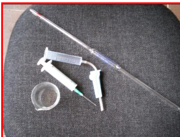
Fotografía 3: Elementos utilizados para la inyección de trazadores.
