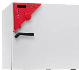
Figura 6: Estufa utilizada en la determinación del contenido de humedad
