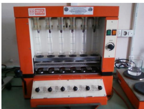
Figura 8: Equipo para determinación de fibra
