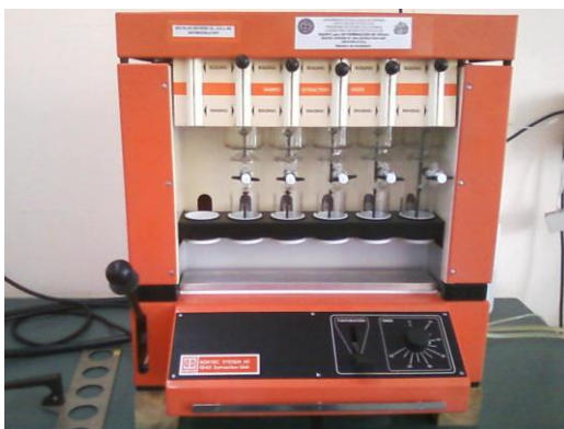
Figura 7: Equipo utilizado para determinación de grasa
