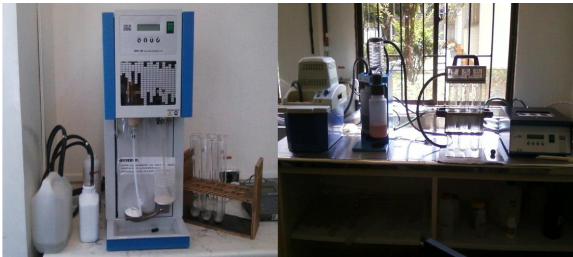
Figura 10: Equipo de micro kjeldahl automático
