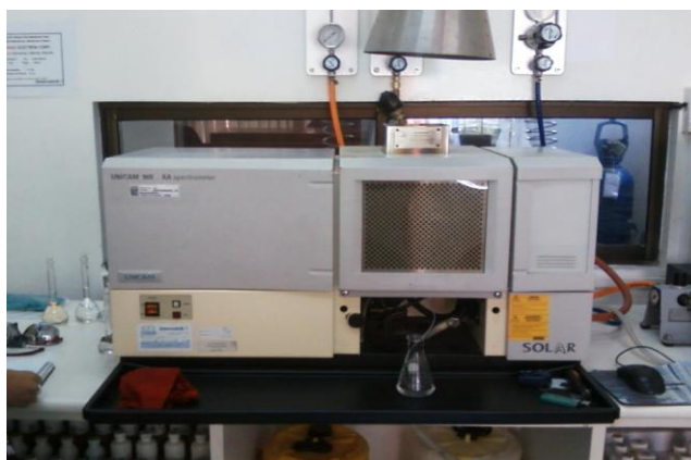
Figura 9: Espectrómetro de absorción atómica
