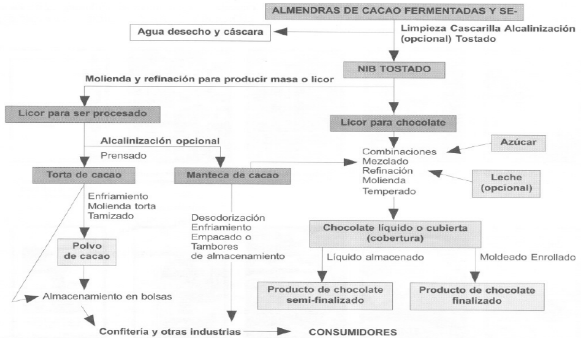
Figura 13. Diagrama Tecnológico de la elaboración del chocolate y sus subproductos, [44]
