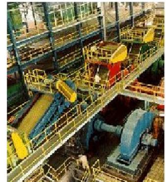
El bagazo que sale del último molino se convierte en el primer subproducto del proceso, que se aprovecha como combustible en las calderas, para producir el vapor utilizado en la generación de energía mecánica y en la generación de energía eléctrica a través de turbogeneradores; el vapor de escape producido en estos equipos, se aprovecha como energía térmica en el proceso de elaboración de azúcar para calentamientos y cocimientos.
