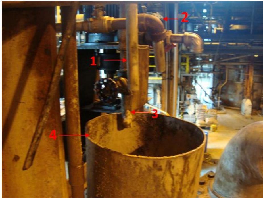
**Figura 10.** Cono de dosificación de floculante. Clarificación de Meladura
