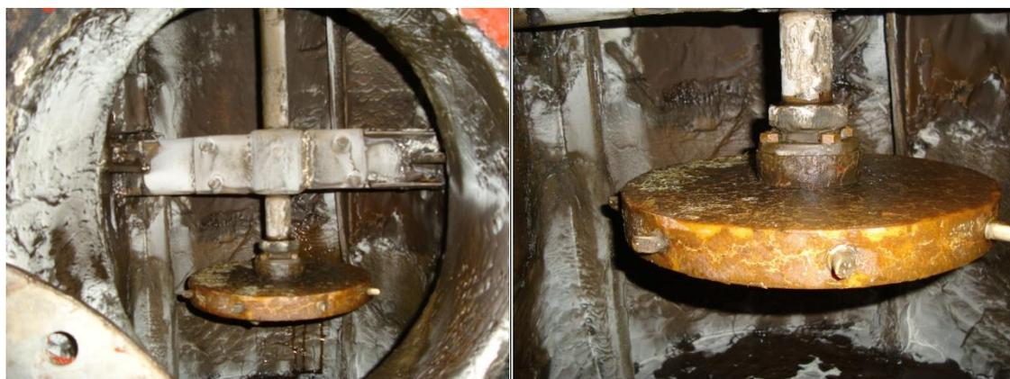
**Figura 9.** *Micronizador. Clarificación por flotación de meladura.*
