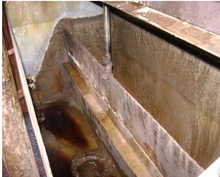
**Figura 16.** Caja de desborde de meladura clarificada.
