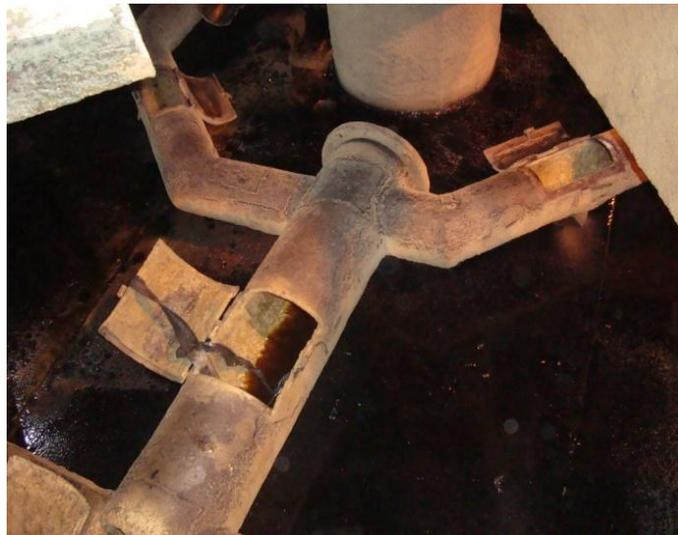
**Figura 14.** Tubería principal para desalajo de meladura (serpentín)
