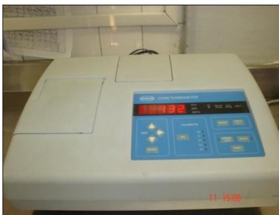
**Figura 19.** Turbidímetro HACH 2100N
