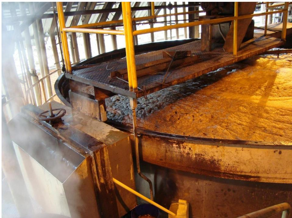
**Figura 12.** Clarificador de meladura. Vista lateral.
