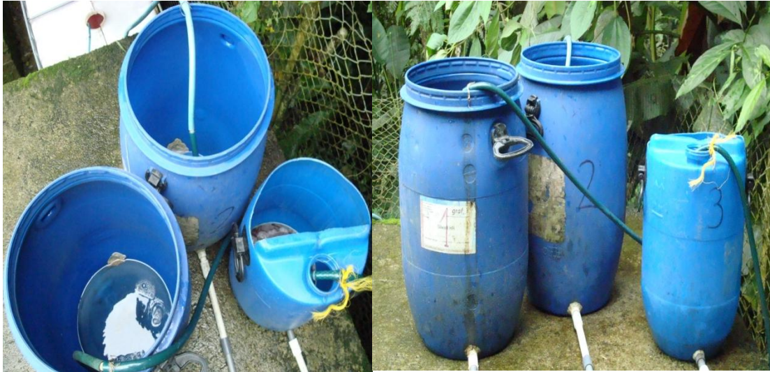
Foto 8: tanque de alimentación secundarios: puntos de muestro afluentes y control de caudal
