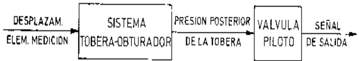
Figura 7. Válvula Piloto (amplificador neumático)
