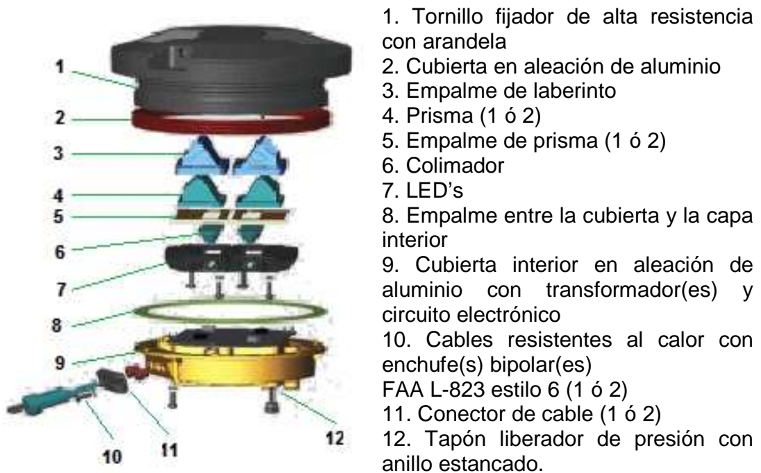
Figura 40. Estructura de una baliza LED de señalización de aeropuertos y vías vehiculares
