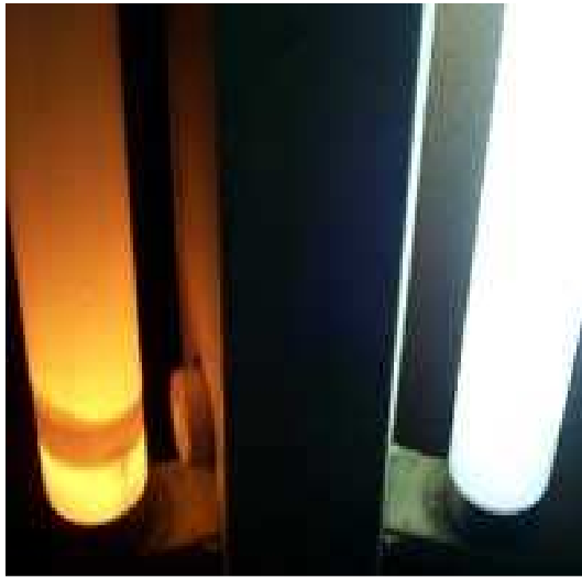
Figura 33. Precalentamiento de una lámpara fluorescente
