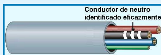
Figura 310-7. Identificación del conductor puesto a tierra.
