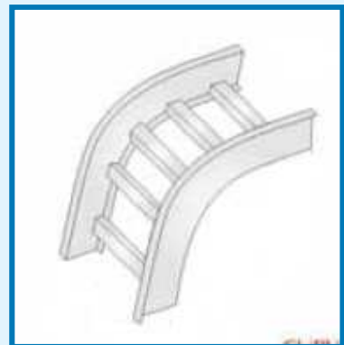
Figuras 318-27 Curva vertical para bajar de 90 grados
