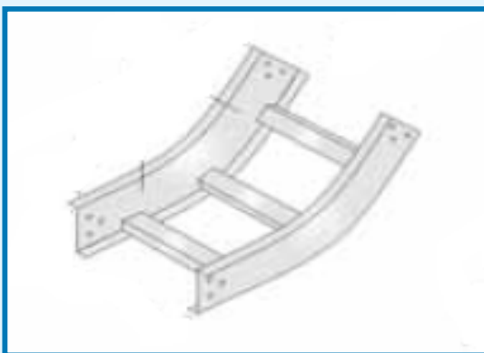
Figura 318-24 Curva vertical para subir de 45 grados
