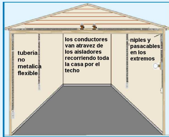
Figura 324-2 Instalación oculta con tubería
