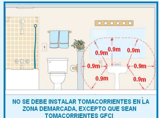
Figura 250-39. Tomacorrientes en lugares húmedos.
