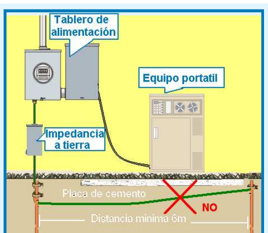
Figura 250-77. Distancias entre electrodos.
