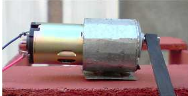
Figura 8. Imagen del motorreductor de la puerta automática.
