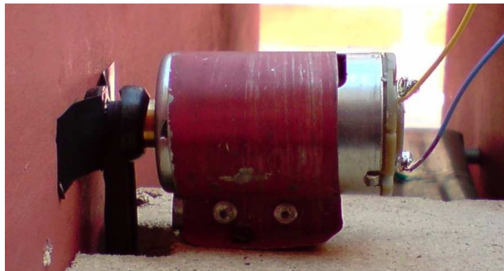
Figura 7. Imagen del motor de la banda transportadora.
