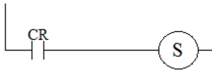
Figura 11.9.: Diagrama Ladder función seguidor
