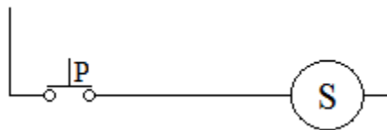
Figura 11.3.: Diagrama Ladder función pulsador
