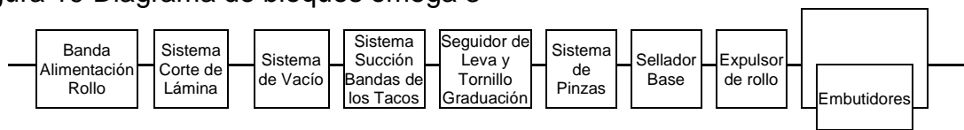
Figura 19 Diagrama de bloques omega 3
