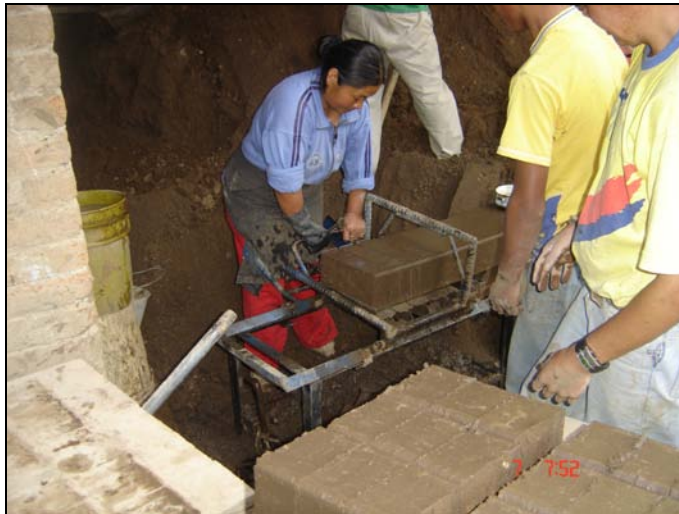
Figura 14. Elaboración de ladrillo.
