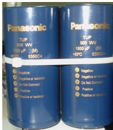
Figura 2.1: Condensadores del bus de continua.
