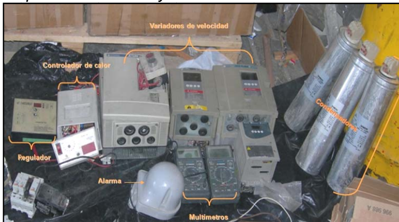
Fotografía 10. Aparatos eléctricos y electrónicos dañados
