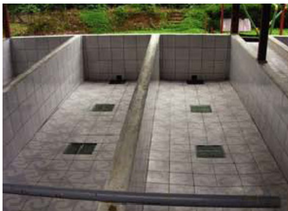
IMAGEN No. 4 TANQUE PARA REALIZAR LA FERMENTACION DEL CAFÉ
