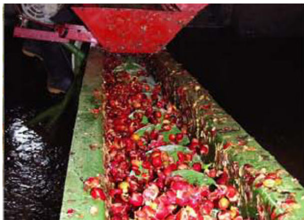
IMAGEN No. 3 DESPULPO O DESCEREZADO DEL CAFÉ
