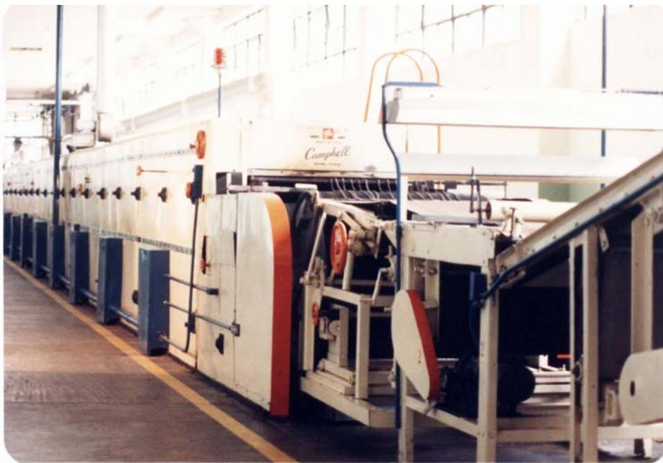
En la figura se pueden apreciar las cajas eléctricas externas de las diferentes zonas de calentamiento que alimentan las resistencias eléctricas, los extractores de gases en la parte superior del horno que son impulsados por motores de corriente alterna, los tambores o cilindros finales por donde rueda la malla metálica donde se deposita el producto y los transportadores finales que reciben el producto para llevarlo a las maquinas de embalaje.
