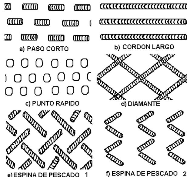
Figura 2. Algunos tipos de cordones de soldadura. [12]
