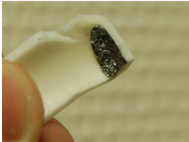
Fig 4 : AlSb molten in alumina crucible
