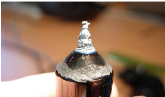
Fig 9 : AlSb « frozen » on the crucible
