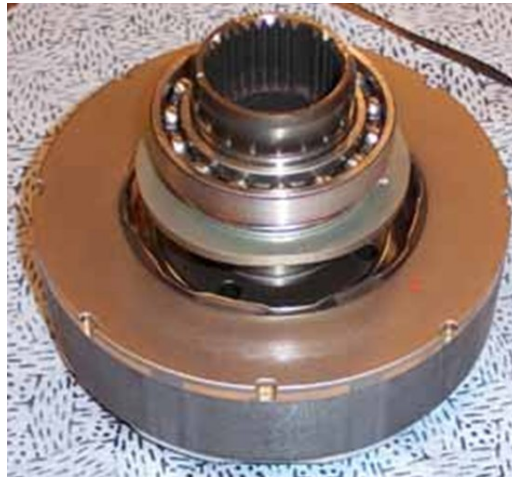
Fig. 2.7. 2004 Prius generator rotor.
