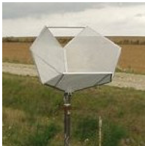
Figure 27. Another example of a trimmed trihedral corner reflector. (courtesy of Institut für Geotechnik und Markscheidewesen).
