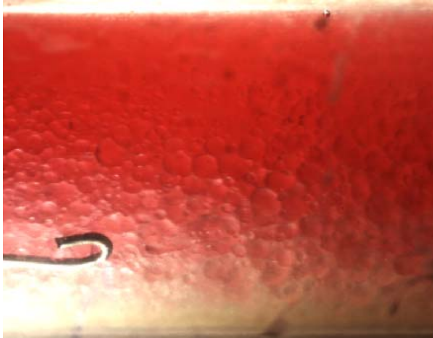
Figure 32 - v_{s0} = 1.000 m/s v_{sw} = 0.400 m/s (DO/W&DW/O)
