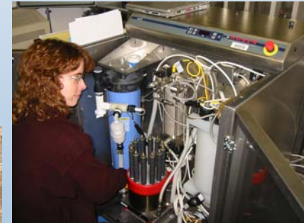
5kW PEM Electrolyzer
