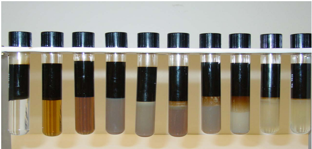
0.0M 0.1M 0.2M 0.4M 0.6M 0.8M 1.0M 1.2M 1.4M 1.8M Figure 6. Salinity scan with \text{Na}_2\text{CO}_3 , 0.05% CS-230
