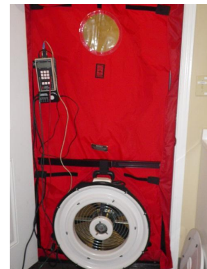
Fig. 23. Blower door setup.
