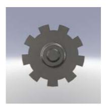
Figure 63: Rotor salient poles
