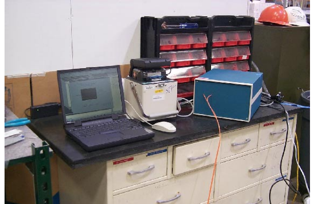
(d) Flow sensor system in indoor flow testing room
