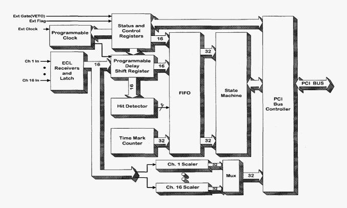
Fig. 1 PATRM/PCI Block Diagram
