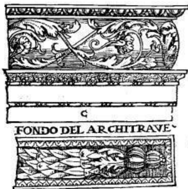
PARTE INTERIORE CHE SOSTIENE IL CIELO
