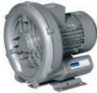
Figura 19. Soplante de la planta piloto.
