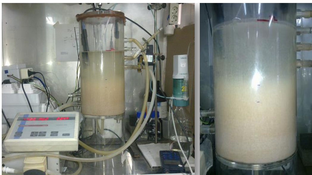
Figura 38. Fotografía del reactor SBR, presencia de azufre elemental.
