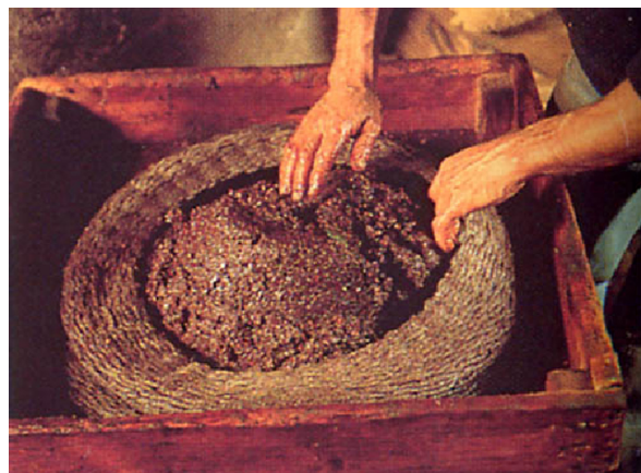
Fig. II.49 : Disposición de la masa de olivas prensada en los capachos. Vantal, 2001, p. 61.
