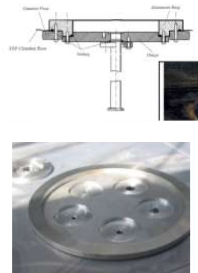
Figura 4-5: Connexió dels ports de mostreig i imatge d'un dels grups de ports de la cambra.
