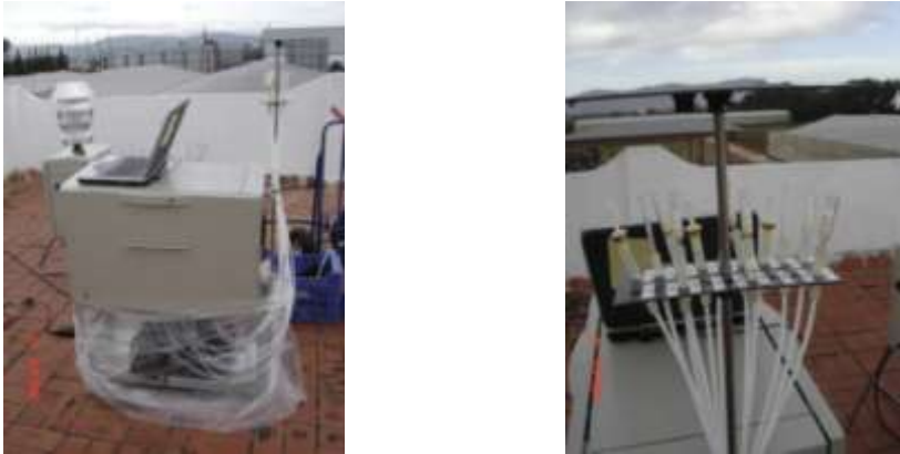
Figura 11-5: Fotografies del sistema de mostreig automàtic, amb el mostrejador d'alt volum al fons i detall dels cartutxos emprats per al mostreig de la fase gas, en la localització de Benicarló.
