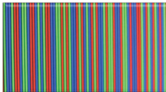
Figura 3. Patrón de código de color formado por 90 líneas verticales paralelas agrupadas en secuencias de 6 líneas que no se repiten en todo el patrón.
