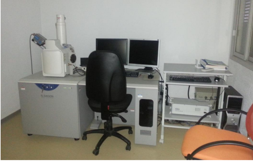
Figura 18: microscopio electrónico de presión variable acoplado a un espectrómetro EDX, propiedad del IVC+R, CulturArts.
