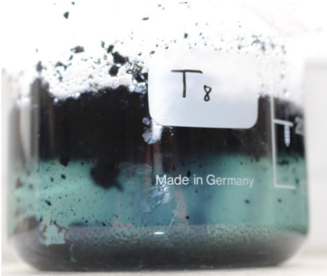
Figura 106: T8 en proceso de reacción del ácido gálico con el sulfato de hierro que dio como resultado el agua coloreada en un tono azulado y sobre la que flotaban o se decantaba los componentes sólidos sin mezclarse.
