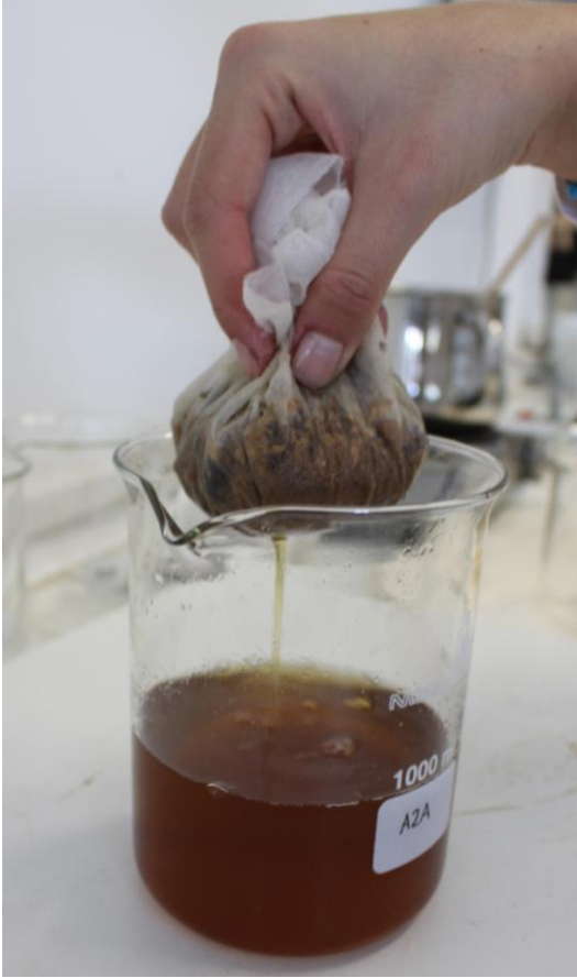
Figura 57: Extracción de las agallas que habían estado macerándose dentro del paño durante días.
