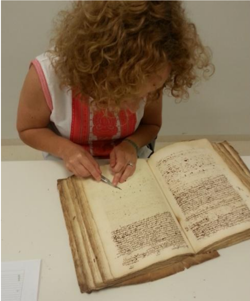
Figura 14: Toma de muestra de tinta de una zona de mancha, en un manuscrito del archivo municipal de Cocentaina.
