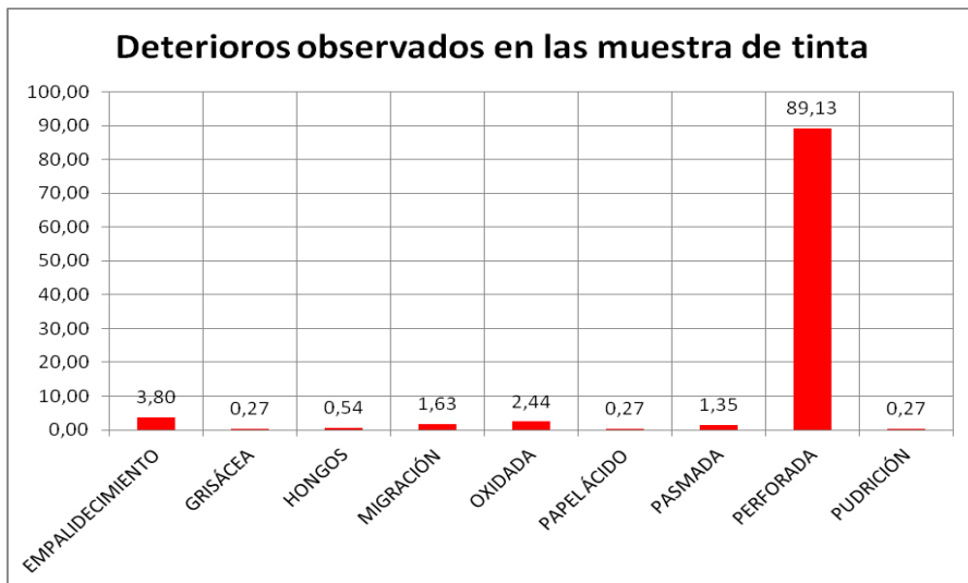
Figura 471: Representación de los deterioros observados en las muestras recogidas en las que se advierte el tipo de daño en porcentajes.
