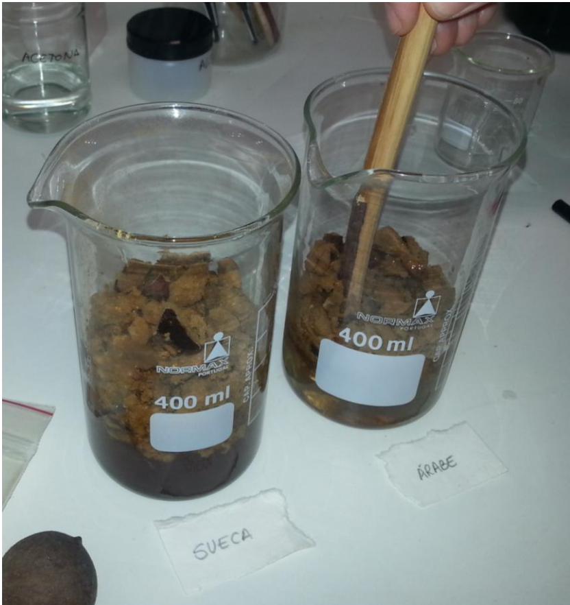
Figura 41: Maceración de las agallas en vino blanco para la receta de Sueca y en agua para la receta andalusí.
