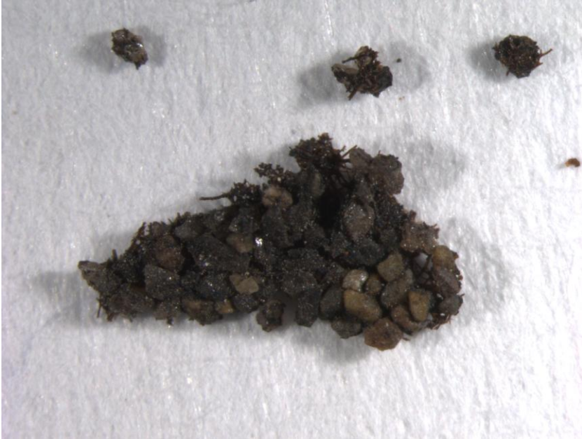
Figura 199: fotografía realizada con lupa binocular en la que se advierten cristales, muy probablemente de los silicatos del secante adheridos en superficie.
